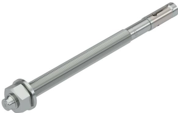
Bolzenanker BZ3 zur Verankerung mittelschwerer bis schwerer Lasten in gerissem oder ungerissenem Beton. Geeignet für hohe Lasten mit geringen Rand- und Achsenabständen. Zum Einschlagen.
