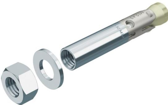
Tassello BZ-IG con filettatura interna per il fissaggio di carichi da medi a pesanti e in calcestruzzo fessurato e non fessurato. Riunisce carichi molto alti sicuri e distanza dei bordi e assiali molto ridotta. Non è necessario un taglio posteriore dei fori.
