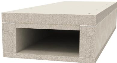
Goulotte coupe-feu composée de béton allégé armé de fibres de verre résistant à l'humidité et au gel de la classe A1 selon EN 13501-1 relative à la pose coupe-feu de câbles dans des voies d'évacuation et issues de secours et pour la sécurité de fonctionnement des installations essentielles à la sécurité. Classification I120 comme goulotte I selon la norme DIN 4102 partie 11 et classification E90 comme goulotte E selon la norme DIN 4102 partie 12.
