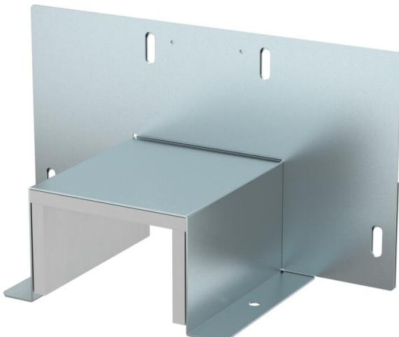
Telaio come isolamento supplementare nell'area di intersezione della pareti con montaggio diretto a parete e a soffitto del BSKM 0711. Inclusa flangia e guarnizioni incollate per la chiusura ermetica delle fughe e guarnizione staccata con la combinazione con contropiasta e vite per l'equipotenzializzazione.
