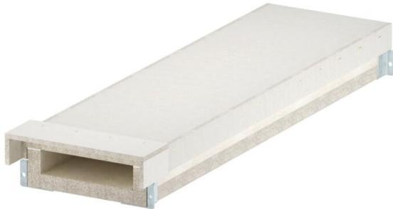
Canale antincendio in calcestruzzo leggero con fibra di vetro resistente all'acqua e al gelo della classe materiali A1 secondo la EN 13501-1 per la posa a prova d'incendio di cavi in vie di fuga e di soccorso e per il mantenimento funzionale degli impianti rilevanti per la sicurezza. Classificazione I90 come canale I secondo DIN 4102 parte 11 e classificazione E30 come canale E secondo DIN 4102 parte 12.
