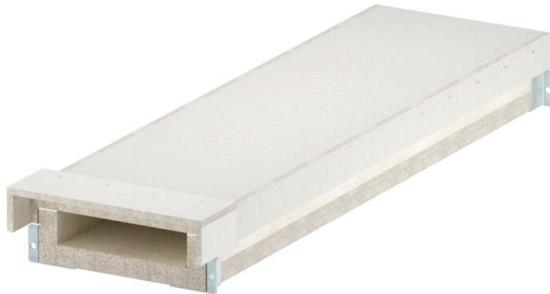
Goulotte coupe-feu composée de béton allégé armé de fibres de verre résistant à l'humidité et au gel de la classe A1 selon EN 13501-1 relative à la pose coupe-feu de câbles dans des voies d'évacuation et issues de secours et pour la sécurité de fonctionnement des installations essentielles à la sécurité. Classification I90 comme goulotte I selon la norme DIN 4102 partie 11 et classification E30 comme goulotte E selon la norme DIN 4102 partie 12.
