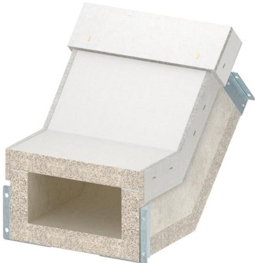
Curva verticale in salita per canale antincendio PYROLINE® Con S, tipo BSKH09-K1021 in calcestruzzo leggero con fibra di vetro resistente all'acqua e al gelo per realizzare variazioni di direzione verticali (45°) nello sviluppo del canale. I materiali di collegamento consentono un rapido montaggio, i coperchi consentono una rapida ispezione e successiva implementazione.
