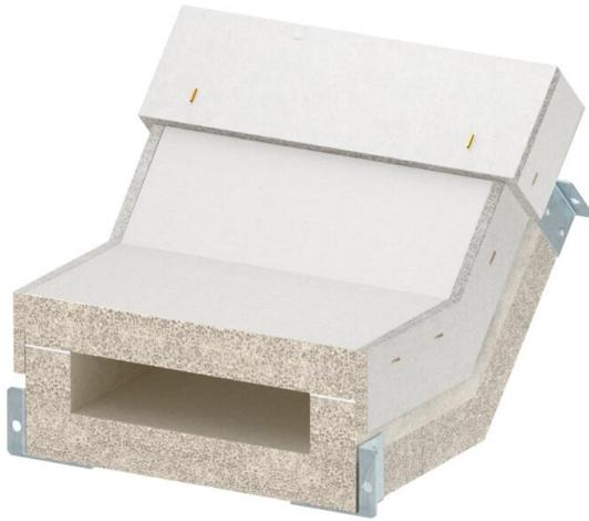
Coude vertical concave pour goulotte coupe-feu PYROLINE® Con S, de type BSKH09-K0521 constitué de béton léger en fibre de verre résistant à l'eau et au gel pour la conception de changements de direction verticaux (45°) dans le sens de la goulotte. Des éclisses d'assemblage prêtes à installer permettent un assemblage rapide des éléments de conduit sur site, et les couvercles simplement posés permettent une inspection et un câblage ultérieur rapides.
