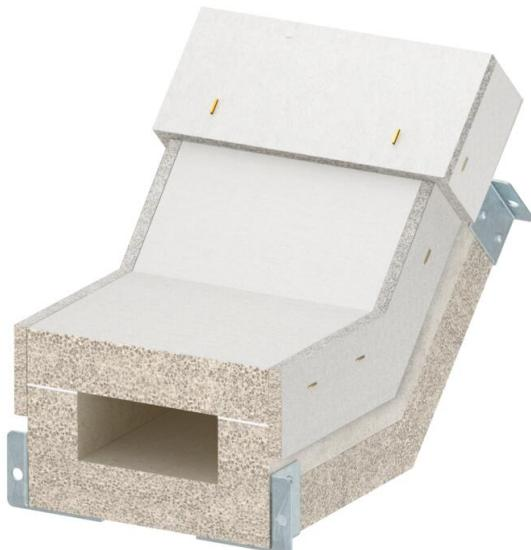
Curva verticale in salita per canale antincendio PYROLINE® Con S, tipo BSKH09-K0511 in calcestruzzo leggero con fibra di vetro resistente all'acqua e al gelo per realizzare variazioni di direzione verticali (45°) nello sviluppo del canale. I materiali di collegamento consentono un rapido montaggio, i coperchi consentono una rapida ispezione e successiva implementazione.
