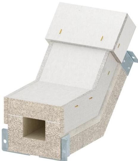
Curva verticale in salita per canale antincendio PYROLINE® Con S, tipo BSKH09-K0506 in calcestruzzo leggero con fibra di vetro resistente all'acqua e al gelo per realizzare variazioni di direzione verticali (45°) nello sviluppo del canale. I materiali di collegamento consentono un rapido montaggio, i coperchi consentono una rapida ispezione e successiva implementazione.
