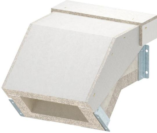
Curva verticale discendente per canale antincendio PYROLINE® Con S, tipo BSKH09-K1021 in calcestruzzo leggero con fibra di vetro resistente all'acqua e al gelo per realizzare variazioni di direzione verticali (45°) nello sviluppo del canale. I materiali di collegamento consentono un rapido montaggio, i coperchi consentono una rapida ispezione e successiva implementazione.
