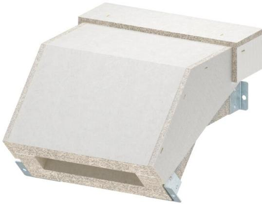
Curva verticale discendente per canale antincendio PYROLINE® Con S, tipo BSKH09-K0521 in calcestruzzo leggero con fibra di vetro resistente all'acqua e al gelo per realizzare variazioni di direzione verticali (45°) nello sviluppo del canale. I materiali di collegamento consentono un rapido montaggio, i coperchi consentono una rapida ispezione e successiva implementazione.
