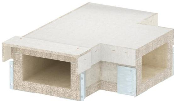
Raccordo a T per canale antincendio PYROLINE® Con S, tipo BSKH09-K1021 in calcestruzzo leggero con fibra di vetro resistente all'acqua e al gelo per realizzare derivazioni a T nello sviluppo del canale. I materiali di collegamento consentono un rapido montaggio, i coperchi consentono una rapida ispezione e successiva implementazione.
