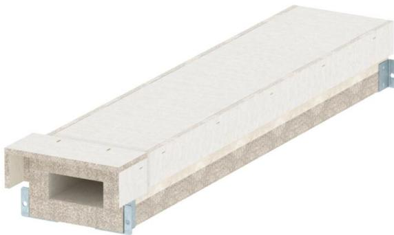
Canale antincendio in calcestruzzo leggero con fibra di vetro resistente all'acqua e al gelo della classe materiali A1 secondo la EN 13501-1 per la posa a prova d'incendio di cavi in vie di fuga e di soccorso e per il mantenimento funzionale degli impianti rilevanti per la sicurezza. Classificazione I90 come canale I secondo DIN 4102 parte 11 e classificazione E30 come canale E secondo DIN 4102 parte 12.
