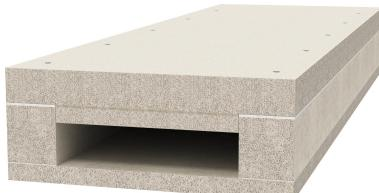
Canale antincendio in calcestruzzo leggero con fibra di vetro resistente all'acqua e al gelo della classe materiali A1 secondo la EN 13501-1 per la posa a prova d'incendio di cavi in vie di fuga e di soccorso e per il mantenimento funzionale degli impianti rilevanti per la sicurezza. Classificazione I120 come canale I secondo DIN 4102 parte 11 e classificazione E90 come canale E secondo DIN 4102 parte 12.
