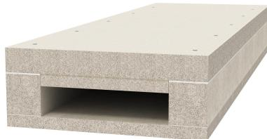
Brandschutzkanal aus wasser- und frostbeständigen Glasfaserleichtbeton der Baustoffklasse A1 gemäß EN 13501-1 zur brandsicheren Verlegung von Kabeln in Flucht- und Rettungswegen und zum Funktionserhalt sicherheitsrelevanter Anlagen. Klassifizierung I120 als I-Kanal gemäß DIN 4102 Teil 11 und Klassifizierung E90 als E-Kanal gemäß DIN 4102 Teil 12.
