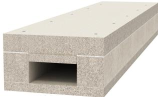
Goulotte coupe-feu composée de béton allégé armé de fibres de verre résistant à l'humidité et au gel de la classe A1 selon EN 13501-1 relative à la pose coupe-feu de câbles dans des voies d'évacuation et issues de secours et pour la sécurité de fonctionnement des installations essentielles à la sécurité. Classification I120 comme goulotte I selon la norme DIN 4102 partie 11 et classification E90 comme goulotte E selon la norme DIN 4102 partie 12.
