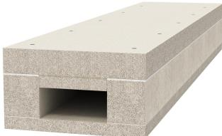
Brandschutzkanal aus wasser- und frostbeständigen Glasfaserleichtbeton der Baustoffklasse A1 gemäß EN 13501-1 zur brandsicheren Verlegung von Kabeln in Flucht- und Rettungswegen und zum Funktionserhalt sicherheitsrelevanter Anlagen. Klassifizierung I120 als I-Kanal gemäß DIN 4102 Teil 11 und Klassifizierung E90 als E-Kanal gemäß DIN 4102 Teil 12.
