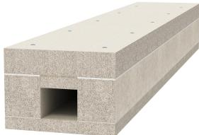
Goulotte coupe-feu composée de béton allégé armé de fibres de verre résistant à l'humidité et au gel de la classe A1 selon EN 13501-1 relative à la pose coupe-feu de câbles dans des voies d'évacuation et issues de secours et pour la sécurité de fonctionnement des installations essentielles à la sécurité. Classification I120 comme goulotte I selon la norme DIN 4102 partie 11 et classification E90 comme goulotte E selon la norme DIN 4102 partie 12.
