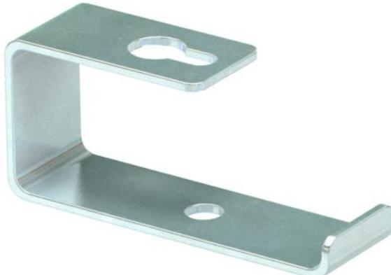
Staffa di separazione come ausilio all'installazione in caso di montaggio a soffitto del canale antincendio PYROLINE® Con D BSK, tipo BSK 090521 e tipo BSK 120521. Montaggio della staffa direttamente ai tasselli di fissaggio del canale antincendio.
