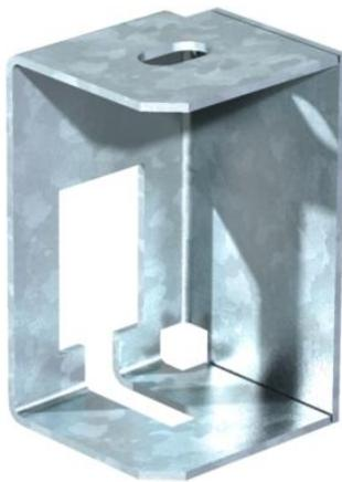
Brandschutzbügel zur Deckenbefestigung der Gewindestangensicherung bei den Verlegearten mit Kabelleitern und Kabelrinnen für den Funktionserhalt nach DIN 4102 Teil 12 und für die Verlegeart mit Kabelrinnen oberhalb von Brandschutzdecken.
