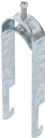
Bride de fixation avec pied W, plaque de pression métallique avec bords arrondis pour la protection des câbles. Pour montage vertical et horizontal de 2 câbles individuels sur des cornières jusqu'à < 40 mm. Avec vis à 1 filet sur plaque de pression, tête de vis hexagonale universelle SW10, avec fente et empreinte cruciforme. Convient au montage en intérieur et en extérieur. L'utilisation d'une contre-plaque est recommandée.
