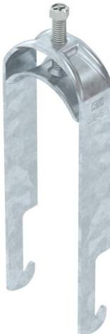
Bügelschelle mit W-Fuß, Metalldruckwanne mit gerundeten Kanten für Kabelschutz. Zur vertikalen und horizontalen Montage von 2 Einzelkabeln an Winkeleisen mit 40 mm Schenkelänge. Mit 1-gängiger Schraube an Druckwanne, universeller Sechskant-Schraubenkopf SW10, mit Schlitz und Kreuzschlitz. Geeignet für Montage im Innen- und Außenbereich. Der Einsatz einer Gegenwanne wird empfohlen.
