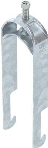
Staffa reggicavo con base a W, coppa in metallo con bordi arrotondati per proteggere il cavo. Per il montaggio verticale e orizzontale di 2 cavi singoli su profili angolari fino a < 40 mm. Con 1 vite a pressione, testa a vite esagonale universale SW10, con fessura e taglio a croce. Per il montaggio in ambienti interni ed esterni. Si consiglia di utilizzare una controcoppa.
