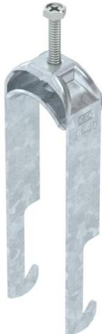
Bügelschelle mit W-Fuß, Metalldruckwanne mit gerundeten Kanten für Kabelschutz. Zur vertikalen und horizontalen Montage von 2 Einzelkabeln an Winkeleisen mit 40 mm Schenkelänge. Mit 1-gängiger Schraube an Druckwanne, univer- seller Sechskant-Schraubenkopf SW10, mit Schlitz und Kreuzschlitz. Geeignet für Montage im Innen- und Außenbereich. Der Einsatz einer Gegenwanne wird empfohlen.
