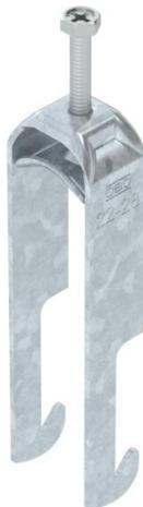
Bügelschelle mit W-Fuß, Metalldruckwanne mit gerundeten Kanten für Kabelschutz. Zur vertikalen und horizontalen Montage von 2 Einzelkabeln an Winkeleisen mit 40 mm Schenkelänge. Mit 1-gängiger Schraube an Druckwanne, universeller Sechskant-Schraubenkopf SW10, mit Schlitz und Kreuzschlitz. Geeignet für Montage im Innen- und Außenbereich. Der Einsatz einer Gegenwanne wird empfohlen.
