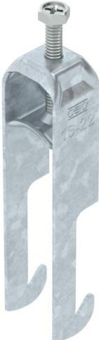
Bride de fixation avec pied W, plaque de pression métallique avec bords arrondis pour la protection des câbles. Pour montage vertical et horizontal de 2 câbles individuels sur des cornières jusqu'à < 40 mm. Avec vis à 1 filet sur plaque de pression, tête de vis hexagonale universelle SW10, avec fente et empreinte cruciforme. Convient au montage en intérieur et en extérieur. L'utilisation d'une contre-plaque est recommandée.
