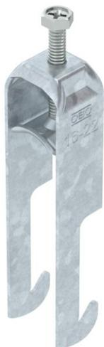
Bügelschelle mit W-Fuß, Metalldruckwanne mit gerundeten Kanten für Kabelschutz. Zur vertikalen und horizontalen Montage von 2 Einzelkabeln an Winkelisen mit 40 mm Schenkellänge. Mit 1-gängiger Schraube an Druckwanne, universeller Sechskant-Schraubenkopf SW10, mit Schlitz und Kreuzschlitz. Geeignet für Montage im Innen- und Außenbereich. Der Einsatz einer Gegenwanne wird empfohlen.
