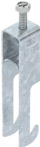
Staffa reggicavo con base a W, coppa in metallo con bordi arrotondati per proteggere il cavo. Per il montaggio verticale e orizzontale di 2 cavi singoli su profili angolari fino a < 40 mm. Con 1 vite a pressione, testa a vite esagonale universale SW10, con fessura e taglio a croce. Per il montaggio in ambienti interni ed esterni. Si consiglia di utilizzare una controcoppa.
