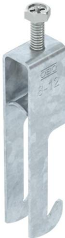
Bügelschelle mit W-Fuß, Metalldruckwanne mit gerundeten Kanten für Kabelschutz. Zur vertikalen und horizontalen Montage von 2 Einzelkabeln an Winkeleisen mit 40 mm Schenkelänge. Mit 1-gängiger Schraube an Druckwanne, univer- seller Sechskant-Schraubenkopf SW10, mit Schlitz und Kreuzschlitz. Geeignet für Montage im Innen- und Außenbereich. Der Einsatz einer Gegenwanne wird empfohlen.
