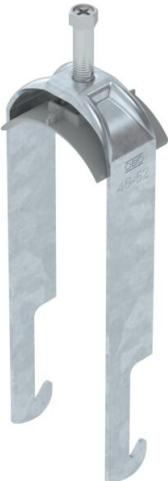
Bride de fixation avec pied W, plaque de pression en matière plastique en polypropylène. Pour montage vertical et horizontal de 2 câbles individuels sur des cornières jusqu'à < 40 mm. Avec vis à 1 filet sur plaque de pression, tête de vis hexagonale universelle SW10, avec fente et empreinte cruciforme. Convient au montage en intérieur et en extérieur. Plusieurs câbles doivent être séparés par des plaques doubles. L'utilisation d'une contre-plaque est recommandée.
