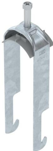
Bügelschelle mit W-Fuß, Kunststoffdruckwanne aus Polypropylen. Zur vertikalen und horizontalen Montage von 2 Einzelkabeln an Winkeleisen mit 40 mm Schenkellänge. Mit 1-gängiger Schraube an Druckwanne, universeller Sechskantschraubenkopf SW10, mit Schlitz und Kreuzschlitz. Geeignet für Montage im Innen- und Außenbereich. Mehrere Kabel sollten durch Doppelwannen getrennt werden. Der Einsatz einer Gegenwanne wird empfohlen.
