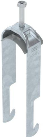
Bride de fixation avec pied W, plaque de pression en matière plastique en polypropylène. Pour montage vertical et horizontal de 2 câbles individuels sur des cornières jusqu'à < 40 mm. Avec vis à 1 filet sur plaque de pression, tête de vis hexagonale universelle SW10, avec fente et empreinte cruciforme. Convient au montage en intérieur et en extérieur. Plusieurs câbles doivent être séparés par des plaques doubles. L'utilisation d'une contre-plaque est recommandée.
