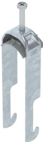
Staffa reggicavo con base a W, coppa in plastica di polipropilene. Per il montaggio verticale e orizzontale di 2 cavi singoli su profilati angolari fino a < 40 mm. Con una vite sulla coppa premente, testa della vite esagonale universale da SW10, a taglio e a croce. Per il montaggio in ambienti interni ed esterni. Più cavi dovrebbero essere separati da coppe doppie. Si consiglia di utilizzare una controcpoppa.
