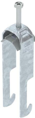
Staffa reggicavo con base a W, coppa in plastica di polipropilene. Per il montaggio verticale e orizzontale di 2 cavi singoli su profilati angolari fino a < 40 mm. Con una vite sulla coppa premente, testa della vite esagonale universale da SW10, a taglio e a croce. Per il montaggio in ambienti interni ed esterni. Più cavi dovrebbero essere separati da coppe doppie. Si consiglia di utilizzare una controcpa.
