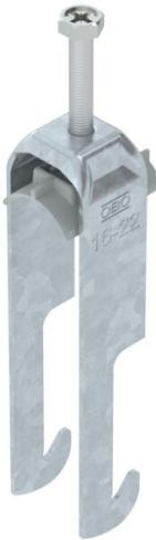
Staffa reggicavo con base a W, coppa in plastica di polipropilene. Per il montaggio verticale e orizzontale di 2 cavi singoli su profilati angolari fino a < 40 mm. Con una vite sulla coppa premente, testa della vite esagonale universale da SW10, a taglio e a croce. Per il montaggio in ambienti interni ed esterni. Più cavi dovrebbero essere separati da coppe doppie. Si consiglia di utilizzare una controcpoppa.
