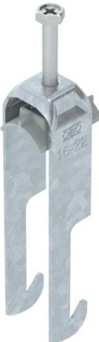
Bride de fixation avec pied W, plaque de pression en matière plastique en polypropylène. Pour montage vertical et horizontal de 2 câbles individuels sur des cornières jusqu'à < 40 mm. Avec vis à 1 filet sur plaque de pression, tête de vis hexagonale universelle SW10, avec fente et empreinte cruciforme. Convient au montage en intérieur et en extérieur. Plusieurs câbles doivent être séparés par des plaques doubles. L'utilisation d'une contre-plaque est recommandée.
