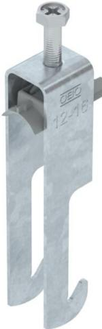
Bügelschelle mit W-Fuß, Kunststoffdruckwanne aus Polypropylen. Zur vertikalen und horizontalen Montage von 2 Einzelkabeln an Winkeleisen mit 40 mm Schenkellänge. Mit 1-gängiger Schraube an Druckwanne, universeller Sechskantschraubenkopf SW10, mit Schlitz und Kreuzschlitz. Geeignet für Montage im Innen- und Außenbereich. Mehrere Kabel sollten durch Doppelwannen getrennt werden. Der Einsatz einer Gegenwanne wird empfohlen.
