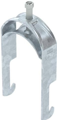
Bride de fixation avec pied W, plaque de pression métallique avec bords arrondis pour la protection des câbles. Pour montage vertical et horizontal d'1 câble individuel sur des cornières jusqu'à < 40 mm. Avec vis à 1 filet sur plaque de pression, tête de vis hexagonale universelle SW10, avec fente et empreinte cruciforme. Convient au montage en intérieur et en extérieur. L'utilisation d'une contre-plaque est recommandée.
