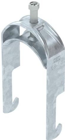
Staffa reggicavo con base a W, coppa in metallo con bordi arrotondati per proteggere il cavo. Per il montaggio verticale e orizzontale di 1 cavo singolo su profili angolari fino a < 40 mm. Con 1 vite a pressione, testa a vite esagonale universale SW10, con fessura e taglio a croce. Per il montaggio in ambienti interni ed esterni. Si consiglia di utilizzare una controcoppa.
