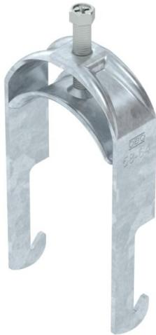
Bügelschelle mit W-Fuß, Metalldruckwanne mit gerundeten Kanten für Kabelschutz. Zur vertikalen und horizontalen Montage von 1 Einzelkabel an Winkeleisen mit 40 mm Schenkelänge. Mit 1-gängiger Schraube an Druckwanne, universeller Sechskant-Schraubenkopf SW10, mit Schlitz und Kreuzschlitz. Geeignet für Montage im Innen- und Außenbereich. Der Einsatz einer Gegenwanne wird empfohlen.
