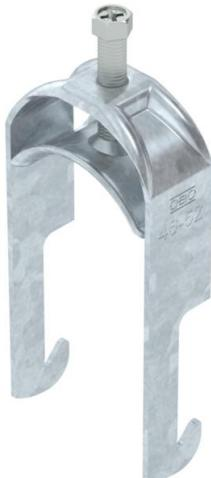
Bügelschelle mit W-Fuß, Metalldruckwanne mit gerundeten Kanten für Kabelschutz. Zur vertikalen und horizontalen Montage von 1 Einzelkabel an Winkeleisen mit 40 mm Schenkelänge. Mit 1-gängiger Schraube an Druckwanne, universeller Sechskant-Schraubenkopf SW10, mit Schlitz und Kreuzschlitz. Geeignet für Montage im Innen- und Außenbereich. Der Einsatz einer Gegenwanne wird empfohlen.
