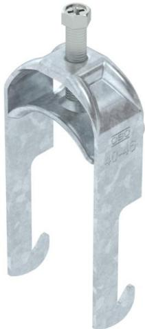
Staffa reggicavo con base a W, coppa in metallo con bordi arrotondati per proteggere il cavo. Per il montaggio verticale e orizzontale di 1 cavo singolo su profili angolari fino a < 40 mm. Con 1 vite a pressione, testa a vite esagonale universale SW10, con fessura e taglio a croce. Per il montaggio in ambienti interni ed esterni. Si consiglia di utilizzare una controcoppa.
