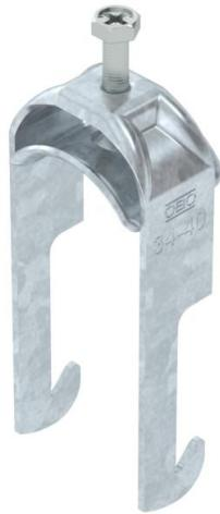
Bügelschelle mit W-Fuß, Metalldruckwanne mit gerundeten Kanten für Kabelschutz. Zur vertikalen und horizontalen Montage von 1 Einzelkabel an Winkeleisen mit 40 mm Schenkelänge. Mit 1-gängiger Schraube an Druckwanne, universeller Sechskant-Schraubenkopf SW10, mit Schlitz und Kreuzschlitz. Geeignet für Montage im Innen- und Außenbereich. Der Einsatz einer Gegenwanne wird empfohlen.
