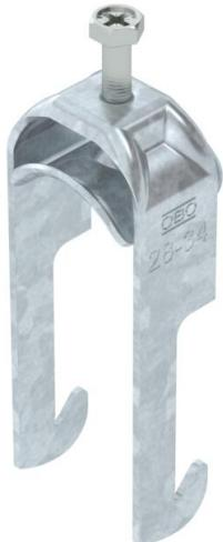
Bügelschelle mit W-Fuß, Metalldruckwanne mit gerundeten Kanten für Kabelschutz. Zur vertikalen und horizontalen Montage von 1 Einzelkabel an Winkeleisen mit 40 mm Schenkellänge. Mit 1-gängiger Schraube an Druckwanne, universeller Sechskant-Schraubenkopf SW10, mit Schlitz und Kreuzschlitz. Geeignet für Montage im Innen- und Außenbereich. Der Einsatz einer Gegenwanne wird empfohlen.
