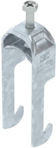
Staffa reggicavo con base a W, coppa in metallo con bordi arrotondati per proteggere il cavo. Per il montaggio verticale e orizzontale di 1 cavo singolo su profili angolari fino a < 40 mm. Con 1 vite a pressione, testa a vite esagonale universale SW10, con fessura e taglio a croce. Per il montaggio in ambienti interni ed esterni. Si consiglia di utilizzare una controcoppa.
