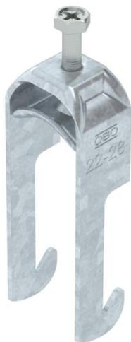
Bügelschelle mit W-Fuß, Metalldruckwanne mit gerundeten Kanten für Kabelschutz. Zur vertikalen und horizontalen Montage von 1 Einzelkabel an Winkelisen mit 40 mm Schenkellänge. Mit 1-gängiger Schraube an Druckwanne, universeller Sechskant-Schraubenkopf SW10, mit Schlitz und Kreuzschlitz. Geeignet für Montage im Innen- und Außenbereich. Der Einsatz einer Gegenwanne wird empfohlen.
