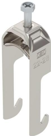
Staffa reggicavo con base a W, coppa in metallo con bordi arrotondati per proteggere il cavo. Per il montaggio verticale e orizzontale di 1 cavo singolo su profili angolari fino a < 40 mm. Con una vite sulla coppa premente, testa della vite esagonale universale da SW10, a taglio e a croce. Per il montaggio in ambienti interni ed esterni. Si consiglia di utilizzare una controcoppa.
