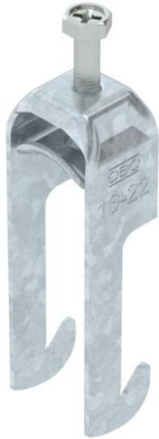
Bügelschelle mit W-Fuß, Metalldruckwanne mit gerundeten Kanten für Kabelschutz. Zur vertikalen und horizontalen Montage von 1 Einzelkabel an Winkelleisen mit 40 mm Schenkellänge. Mit 1-gängiger Schraube an Druckwanne, universeller Sechskant-Schraubenkopf SW10, mit Schlitz und Kreuzschlitz. Geeignet für Montage im Innen- und Außenbereich. Der Einsatz einer Gegenwanne wird empfohlen.
