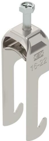
Bügelschelle mit W-Fuß, Metalldruckwanne mit gerundeten Kanten für Kabelschutz. Zur vertikalen und horizontalen Montage von 1 Einzelkabel an Winkeleisen mit 40 mm Schenkelänge. Mit 1-gängiger Schraube an Druckwanne, univer- seller Sechskant-Schraubenkopf SW10, mit Schlitz und Kreuzschlitz. Geeignet für Montage im Innen- und Außenbereich. Der Einsatz einer Gegenwanne wird empfohlen.
